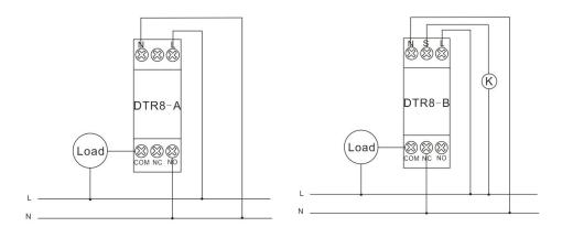
Delay on:connect the COM and NO
