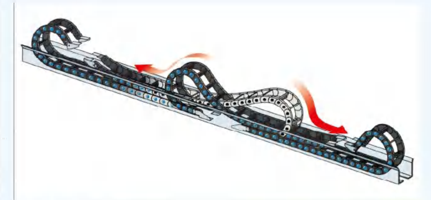
拖链长距离水平运动 Long horizontal-2 chain
