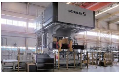
SpeedLine，每分钟最高产出为6冲次。另一家中国的汽车供应商已经引进了第二套该系列设备为其欧洲客户生产轻量化零部件。两条冲压线的压力都达到了1200 t。第一条生产线于2022年4月投入运营，第二条将于2024年4月投入运营。天津泰正公司的Strongline也计划于2024年年初投入生产。
