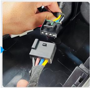
6. 将原车电源与冰箱一分二电源连接
