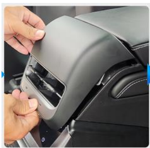
9. 安装出风口, 升级完成
