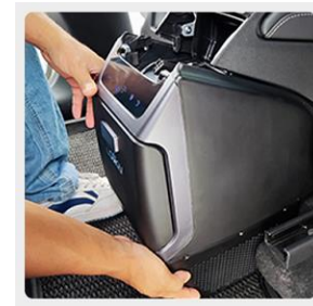
7. 将冰箱与原车卡口对接 (注意电源线塞进缝隙中)
