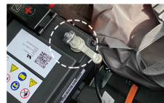
32.装回步骤2尾箱副电池负极，踩刹车给车辆通电，安装完成
