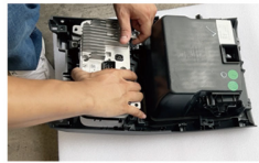
13.拔出空调控制器
