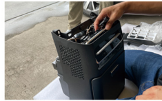
17.把原车空调控制器装在车载冰箱上
