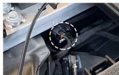
31.插回步骤3维修插头
