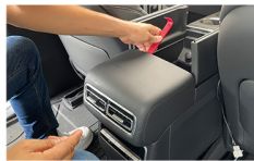
7.撬开二排空调出风口外壳
