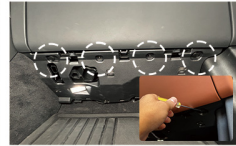
4.拧出副驾储物箱下面4颗螺丝，拆开挡板
