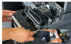
29.把控制面板底部的胶布薄膜撕开，对准卡扣位，按压安装
