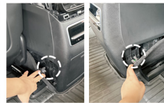
8.撬开二排储物箱两侧饰板，拧出图中两颗螺丝
