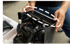
16.拆出车载冰箱上的控制面板
