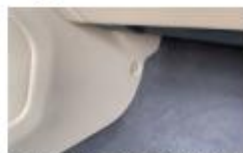
8. 使用撬板撬开副驾驶储物箱下方的圆形卡扣
