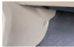
24. 装回中控右侧挡板后重新装上步骤8中的卡扣
