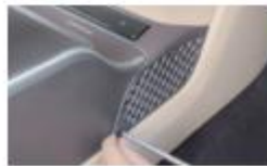
25. 安装配件装饰板,打上左右共4颗螺丝固定
