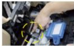
21. 拔出后排挡板黄圈处插头
