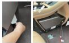
12. 撕开冰箱侧方贴纸后对准位置推进安装
