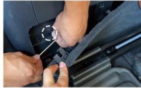
10.拧出储物箱两侧饰板内 图示两颗螺丝
