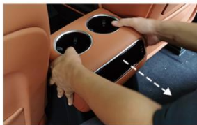
13.将杯架底座往后拔出
