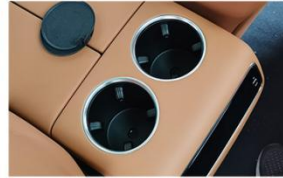
11.取出杯槽内的硅胶垫 (注:L6、L7车型无需拆杯槽螺丝, 参考步骤13向后方拔出即可)
