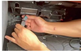
6.更换上冰箱一分二电源线 一端连接拔下的电源线
