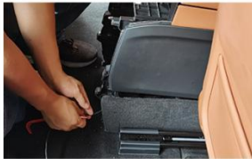
9.撬开储物箱左右两侧饰板 露出冰箱电源线插头
