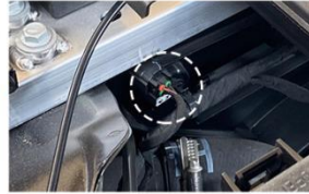
3.打开前机盖，拔掉维修插头
