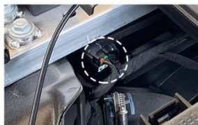
26.插回步骤3维修插头
