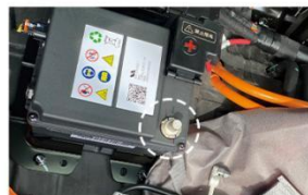
27.连接步骤2副电池负极线
