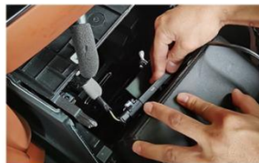
18.将传感器安装到冰箱背后插口 (注:L6 L7车型无此步骤)
