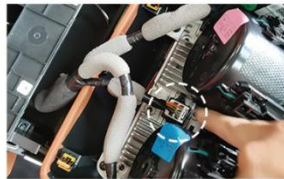
14.拔出杯架底座上的后排空调 面板电源线(如图示)
