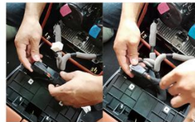
23.将后排空调面板电源线与冰箱 顶部母插相连
