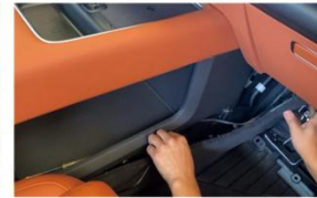
8.将电源线藏入饰板中,并延伸至 扶手箱后方
