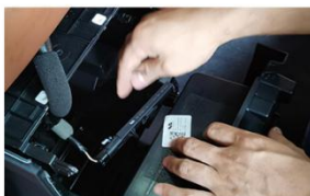
17.拔出储物箱后方的传感器 (注:L6 L7车型无此步骤)
