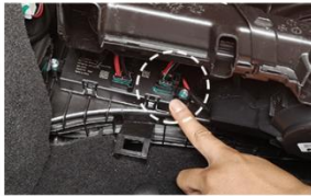
5.拔出图示中的电源线插头 (L6、L7电源线插头在风机右侧)
