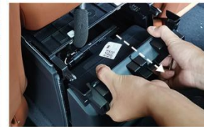
16.往后拔出储物箱(不可用力过度 注意储物箱后方电源线)
