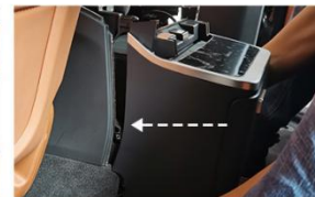
20.将冰箱卡扣对准扶手箱卡槽推入 确保卡扣到位
