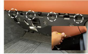
4.拧出图示4颗螺丝，拆开挡板
