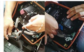
24.将冰箱顶部电源线另一端 公插与杯架底座连接
