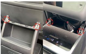
21.将储物箱上方两卡扣拆下 安装到冰箱对应位置 (注:L8车型无此步骤)
