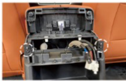
13. 拧出储物箱顶部两颗螺丝
