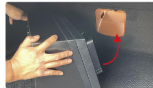
2.将冰箱门板对准后排座椅中央小孔往前推,直至贴合座椅后背(注:冰箱门板需完全卡进孔中)
