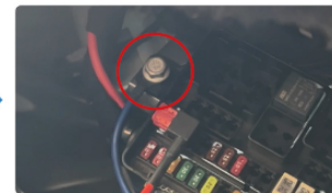
6.将蓝色电源线接到负极搭铁螺丝并拧紧(注:红线为正极,蓝线为负极)
