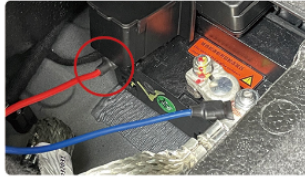
5.将配套电源线红色一端连接电瓶正极(注:红线为正极,从盒下方接入)
