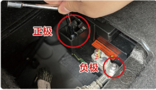
4.用13号套筒拧下电瓶正负极螺丝
