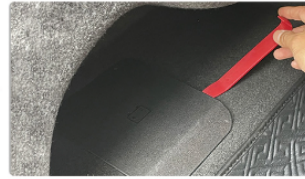
3.用翘板撬开后尾箱左侧电池上盖
