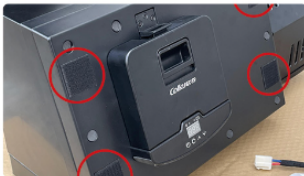
1.将配备的魔术贴粘贴在冰箱正面四个角
