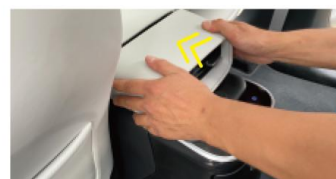
18. 将原车空调出风口装回原位 (完成)
