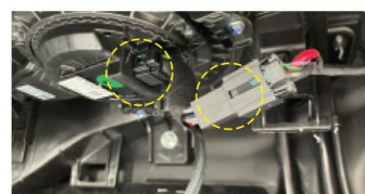
9. 连接配件中的一分二电源线，注另一端插回步骤8位置
