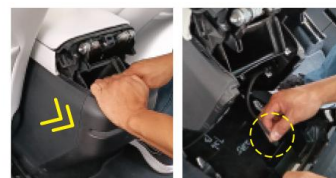
3. 慢慢拉出储物箱，拔出黄圈处电源插头
