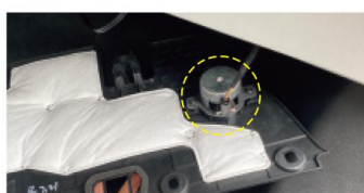
11. 重新连接黄圈处插头
