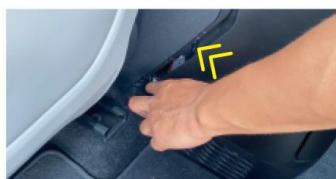
17. 对准卡扣位，按压安装冰箱
