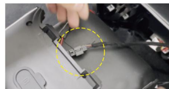
15. 将步骤3电源插头连接冰箱上方黑色接口
