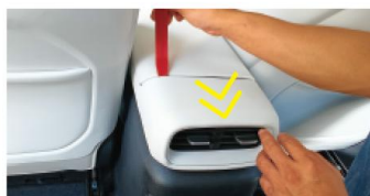
2. 使用撬板工具撬开后排空调出风口外壳
