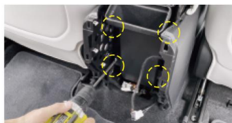
14. 装上配件中的空调导风管，打上原螺丝固定
