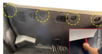
6. 用撬板工具撬开副驾储物箱底下4颗圆形卡扣
