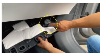
7. 拔出黄圈处插头后才可完全拆开挡板
