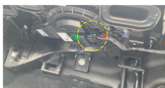
8. 拔出黄圈处原车空调风机电源插头
