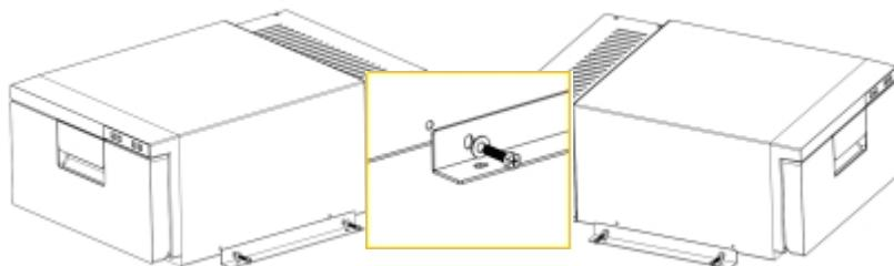
如图使用配件中的螺丝将冰箱支架安装固定于冰箱两侧
