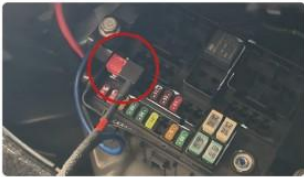
4.将冰箱红色电源线插入图示中的卡槽位置(注:第二排左起第三卡槽位)
