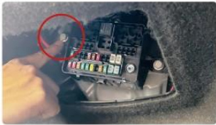
5.用扳手拧下车身负极搭铁螺丝(如图所示)
