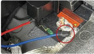
6.将电源线蓝色一端连接电瓶负极(注:蓝线为负极)
