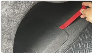
3.用翘板撬开后尾箱左侧电池上盖
