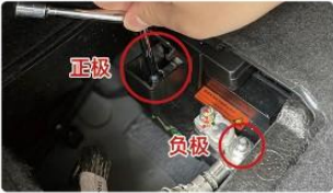
4.用13号套筒拧下电瓶正负极螺丝
