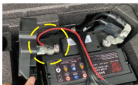
14. 使用10号套筒连接配件 电源线正极(红线)
