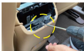
29. 装回后饰板, 打上黄圈 处螺丝固定
