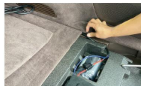
16. 将电源线埋入右侧缝隙, 合上盖板
