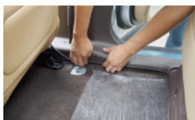
18. 继续将电源线埋入右侧 脚踏饰板隐藏
