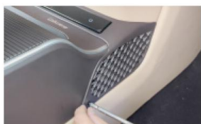
25. 安装配件装饰板, 打上 左右共4颗螺丝固定
