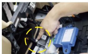
21. 拔出后排挡板黄圈处插 头
