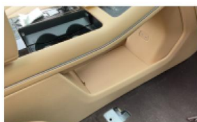
9. 直接移除扶手箱下方垫 板
