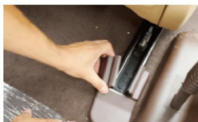
6. 移除副驾驶座位下方前 后共4个保护盖
