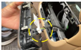
2. 拔出黄圈处插头
