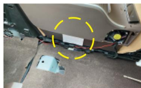
23. 将红线埋入底部缝隙, 撕掉黄圈处贴纸
