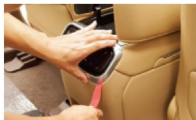
1. 打开扶手箱后用撬板拆 开扶手箱显示屏
