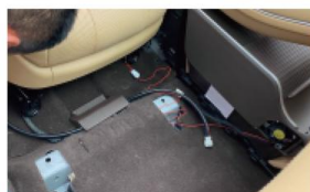
19. 将电源线通过副驾座位 下方, 走向如图
