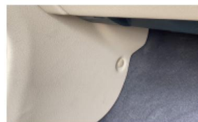
24. 装回中控右侧挡板后重 新装上步骤8中的卡扣
