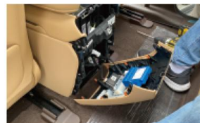
4. 使用撬板辅助拆除后饰 板
