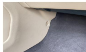
8. 使用撬板撬开副驾储物 箱下方的圆形卡扣
