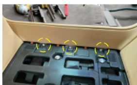
10. 拧出侧方黄圈处3颗螺 丝
