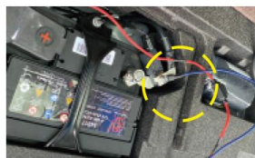
15. 连接配件电源线负极 (蓝线)
