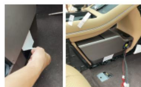
12. 撕开冰箱侧方贴纸后对 准位置推进安装
