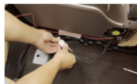
20. 连接冰箱和电源线插头, 并将红线伸向后排
