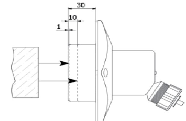
限位二级跑偏：触发一级跑偏信号，皮带持续跑偏直触头动作行程10mm，触发二级跑偏信号
