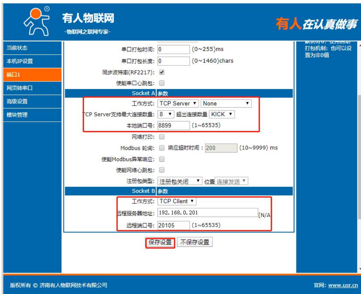
图 13 Socket A/Socket B 设置方法
