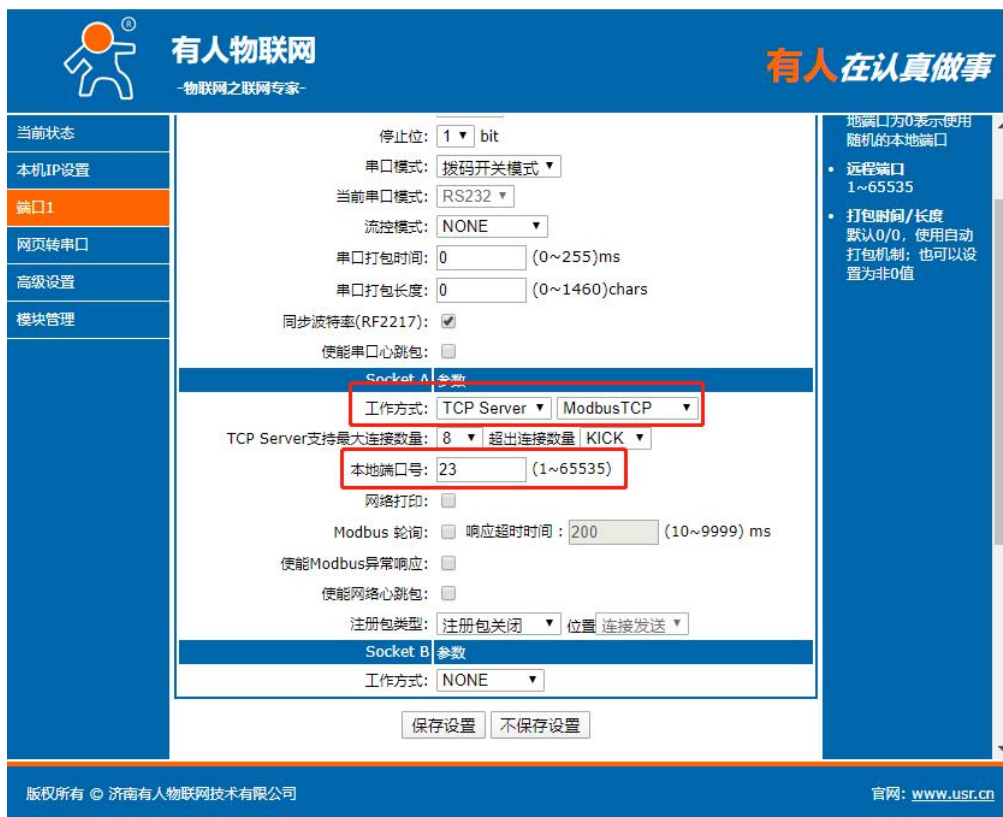
图 45 Modbus RTU 转 Modbus TCP
