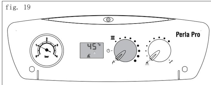
冬季模式 (fig. 20)：旋转模式选择钮至暖气片区域，进入冬季模式，可以提供生活热水和采暖。当需要采暖时，锅炉启动，显示屏显示出水温度、采暖图标和火焰图标。当需要生活热水时，显示屏显示出水水温，生活热水图标和火焰图标。LED指示灯为绿色常亮。
