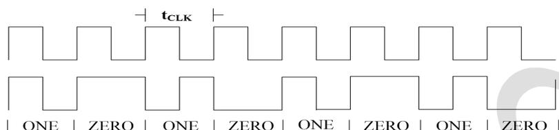
通信包中的每个字节包括异步串行格式中的11位，如下所示：
