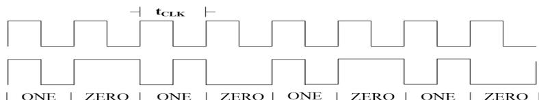
通信包中的每个字节包括异步串行格式中的11位，如下所示：
