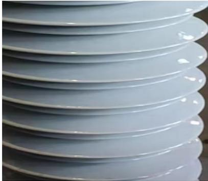
图 3 烧成后的灰釉绝缘子表面
