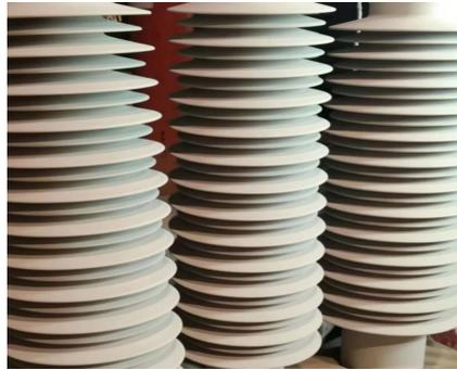
图 1 等静压成形的棒形瓷绝缘子坯体
