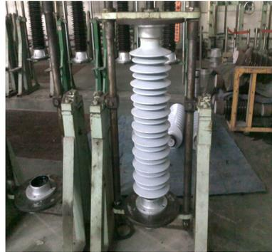
图 4 正在胶装的灰釉瓷绝缘子产品
