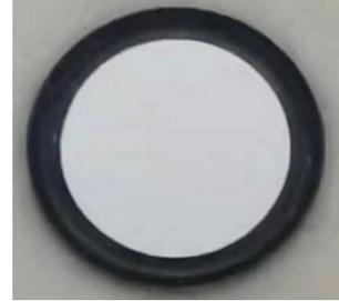
二、主要用途：用于制作各种高温整流二极管，用于各种电器、电机及电子电路中整流用。
