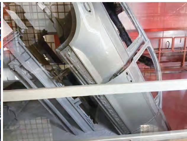
超低温电泳技术已应用于大众安徽新能源汽车
