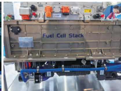
清能股份展示的250 kW的电堆和200 kW的系统，采用了石墨金属复合板的独特技术路线
