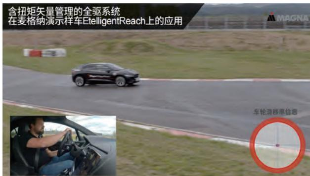
而在最终的实车表现方面，驾驶员在操控麦格纳的样车EtelligentReach时，仅需对转向盘作微小幅度的操作，车辆便可进行灵活的转向操作，这都源自于先进的车辆控制软件对前后左右车轮扭矩的控制，好比优秀的司机会在同一时间及时精准地操作4个加速踏板和4个制动踏板。
