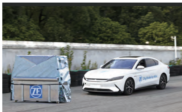
搭载新型干式线控制动系统的采埃孚展车在试验场障碍物前紧急刹车
