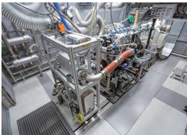
TCD 7.8 H 2 发动机在马勒进行台架试验
