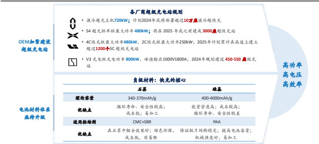
图7 小三电系统：充电系统、电池材料体系全面升级
