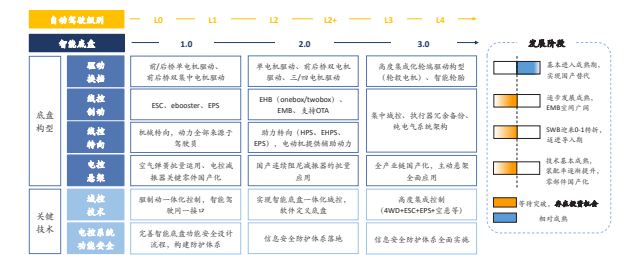
图9 汽车迈向高级别自动驾驶，线控底盘从1.0向2.0阶段发展
