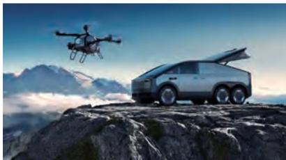
小鹏汇天通过自研，开发出全球首个车载自动分合机构，一键操作便可实现陆行体和飞行体的自动分离、结合。分离后，展开飞行体的6副机臂和旋翼，即可开启低空飞行；飞行体落地后，收拢6副机臂和旋翼，通过陆行体的自动驾驶功能和自动分合机构，实现与飞行体的精准对接、结合。这个突破性的创新，可以解决传统飞机在使用过程“移动难”、“储存难”两大痛点问题。陆行体不仅是一个移动平台，也是一个存储、补能平台，是名副其实的“陆地航空母舰”，让用户实现“随心移动，自由飞行”。
