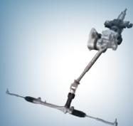
“合”平台管柱式电动助力转向系统
