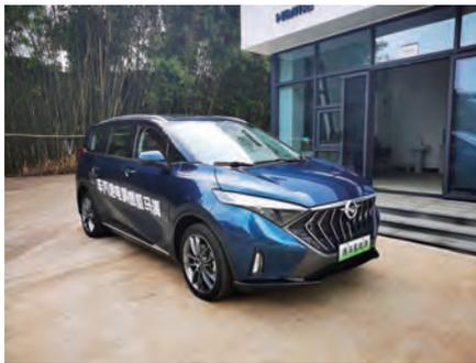
搭载舜华生产的车载氢系统的海马70兆帕氢燃料电池乘用车
