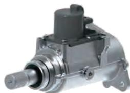
该产品基于舍弗勒成熟可靠的单向离合器开发而成。系统借助电磁铁和型线推板，巧妙利用轮端动力实现脱开。与电机执行器相比，电磁铁不仅能耗更低，控制器的软硬件也相对更加简单，有助于提高系统可靠性。与市场其它方案不同的是，该系统采用径向结合方式，有效避免轴向结合因齿轮冲击带来的顿挫感，结合过程非常平顺，确保舒适的驾乘体验。得益于机械自锁及弹簧保持功能，系统具有非常高的可靠性，一旦结合可以使车辆保持稳定的四驱模式。
