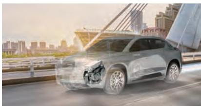
为应对在乘用车和商用车中集成纵置混动系统的挑战，DHD Duo采用了紧凑且高度集成的犬齿离合器技术。这使得DHD Duo系统可以在多种车型上应用，无需进行结构修改，从而为汽车制造商带来无与伦比的灵活性。
