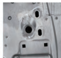
图7 侧围外板定位孔刚度不足
