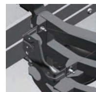
图5 前大灯支架定位结构不稳定
