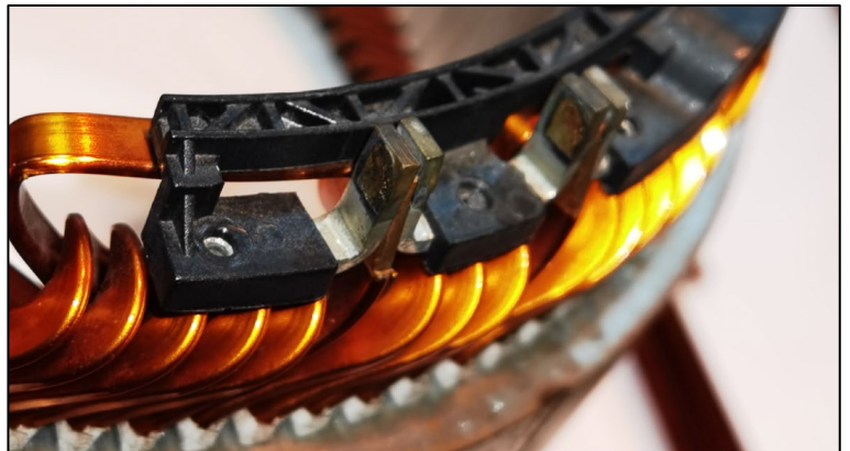
动力马达Busbar
