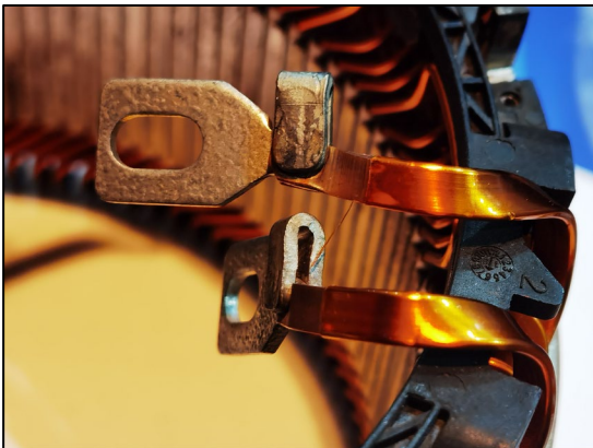
动力马达Busbar
