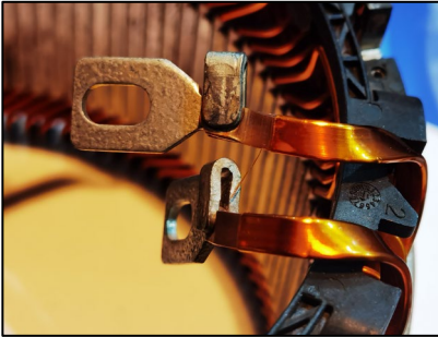
动力马达Busbar
