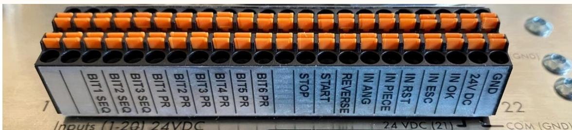
如要连接，只需将电缆或卡套直接推入相应的孔中即可。
