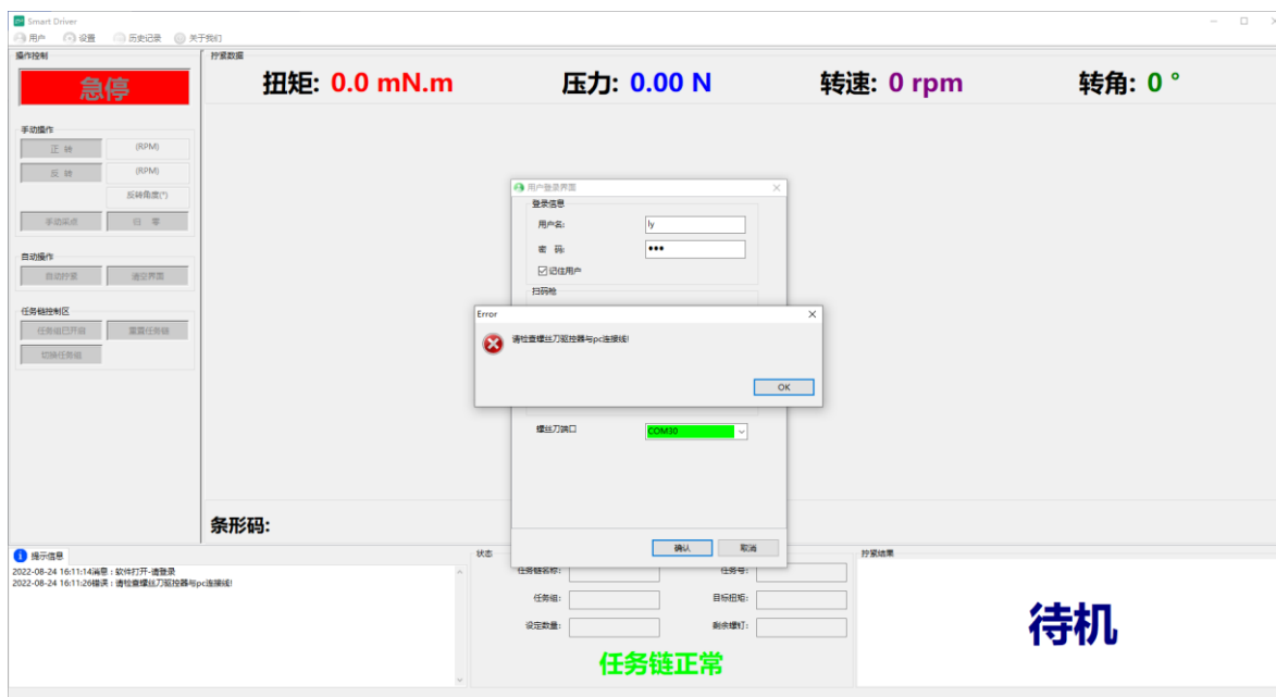
图 9 串口登录驱动器连接错误界面
