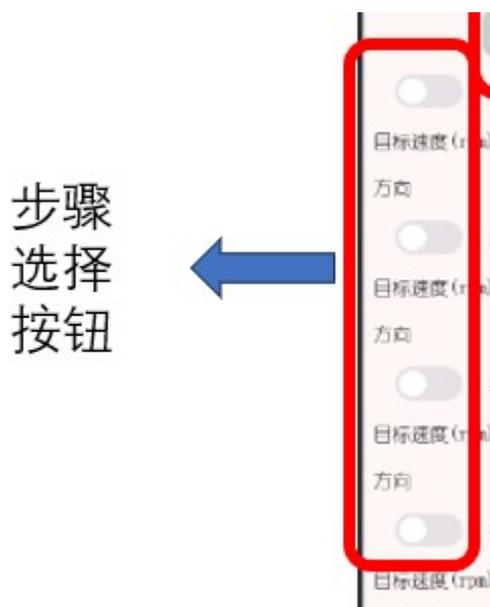
注意：使能某一步骤或修改某一步骤时请先按左边白色圆圈，变绿后代表步骤 已打开，再点击中间文字就会进入修改参数界面。
