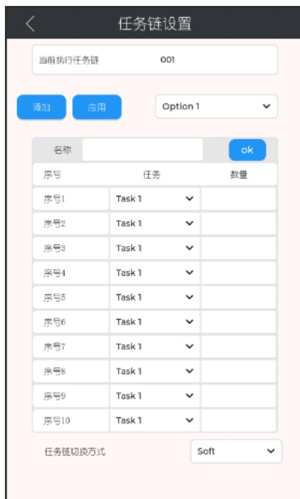
点击【添加】按钮，写入任务链名称，任务组默认为“任务 1 组”，用户可根据需求设置多个任务组，通过下拉框进行选择，并写入相对应的螺钉数量并设置任务链的名称。如图所示。
