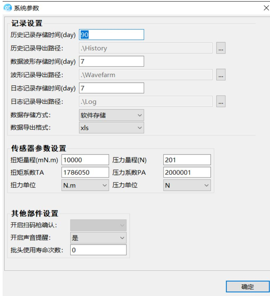
图 31 螺丝刀系统参数对话框
