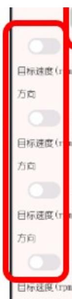
注意：使能某一步骤或修改某一步骤时请先按左边白色圆圈，变绿后代表步骤 已打开，再点击中间文字就会进入修改参数界面。
