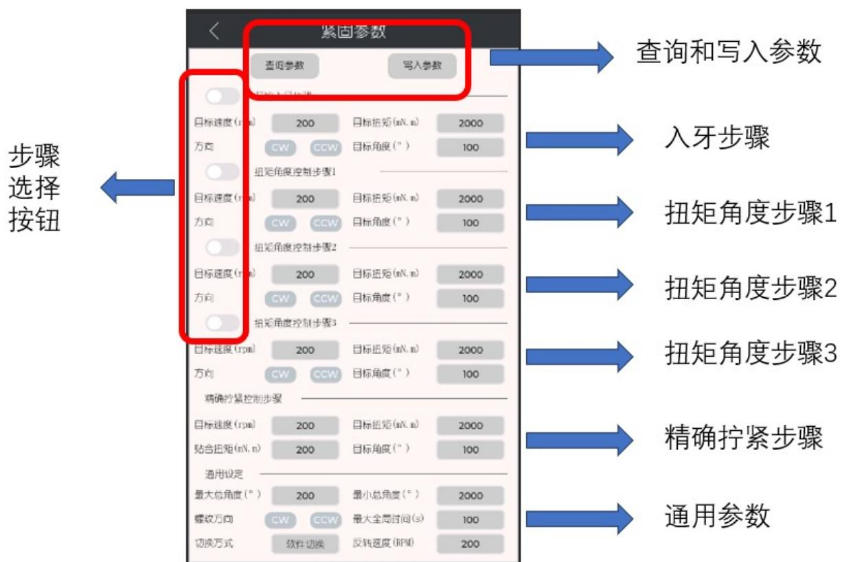
发货前，我方已在控制器内预先写好了拧紧参数，用户可以到紧固参数界面直接选择使用，因为实际工况不同，预设的参数可能不满足精度要求，用户可根据实际情况，自行设置修改，修改后点击“写入参数”生效。。
