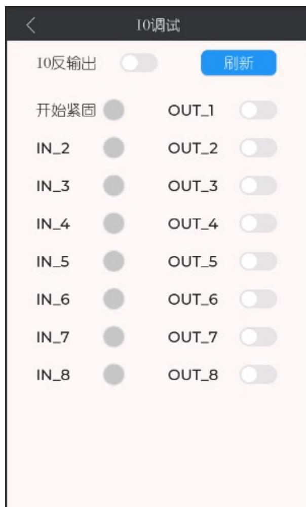
此界面可显示 IO 的状态，并且操控输出 IO；
