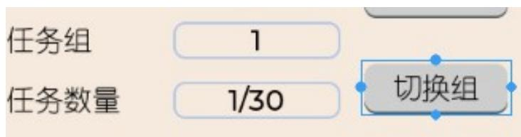
(2) 自动切换：任务链处于该切换方式时，一个任务组工作结束后会自动切换到下一个任务组中。此时【切换组】不可使用的。切换方式如图所示。
