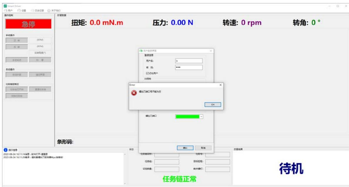
图 10 连接螺丝刀端口为空提示界面
