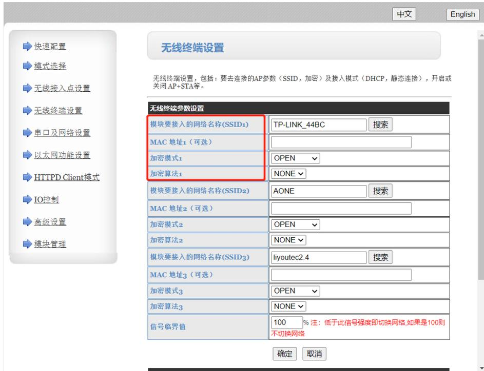
若需指定无线工具接入路由器的 IP 地址，则需要将模块 IP 地址设置更改为静态 (固定 IP)，如下图。
