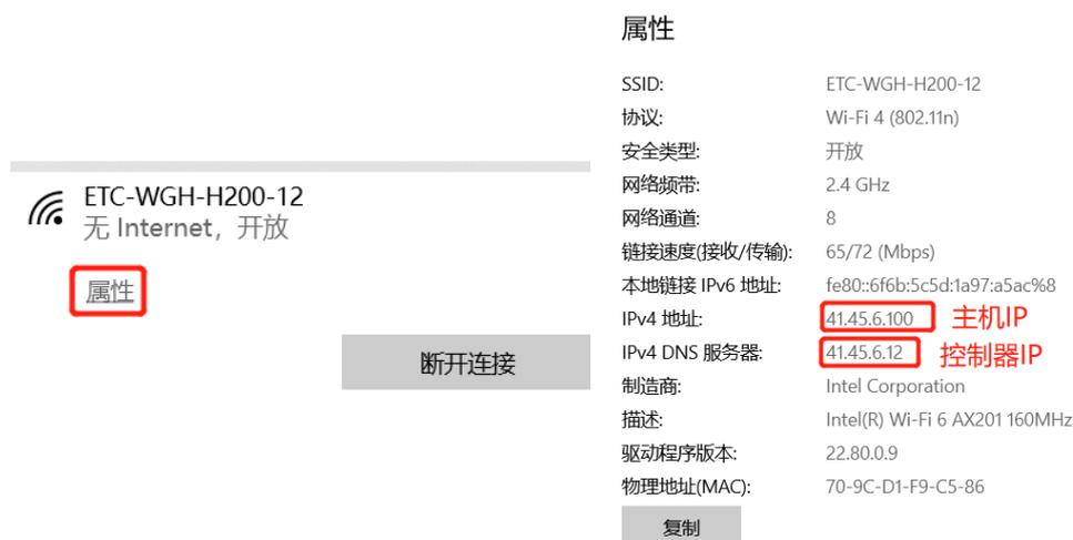
打开软件登录界面，将查询到的网络参数数据如图写入控制器通信端口设置文本框。其中，“设备 IP 地址”对应上图“控制器 IP 地址”；设备端口默认为 5000；“本地 IP 地址”对应上图“主机 IP”；本地端口默认为 7890。
