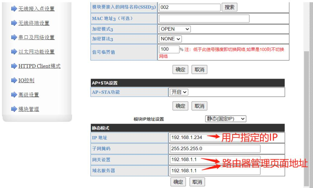
设置成功后提示重启，如下图。此时将无线工具断电后等待 3 秒以上再上电即可自动连接到指定的路由器。
