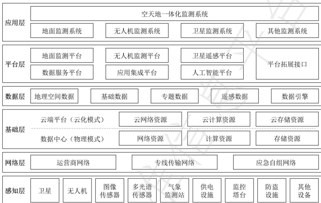
图4 空地一体化监测系统逻辑架构图
