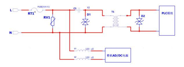
说明:图中 T1 变压器为 4:3 变压器;C1 安规电容推荐选择 100nF 安规电容;初次级双向 TVS 或 TSS 保护管(D1/D2)为必选(要求结电容越小越好);L/N 线上 PLC 信号接入点需要在压敏电阻(RV1)后面,压敏电阻结电容建议小于 600pF。PLC 信号后面需串接两个差模电感(L1/L2)与整机电源做隔离,差模电感感值推荐大于 100uH。如下为部分上述物料的推荐型号。
