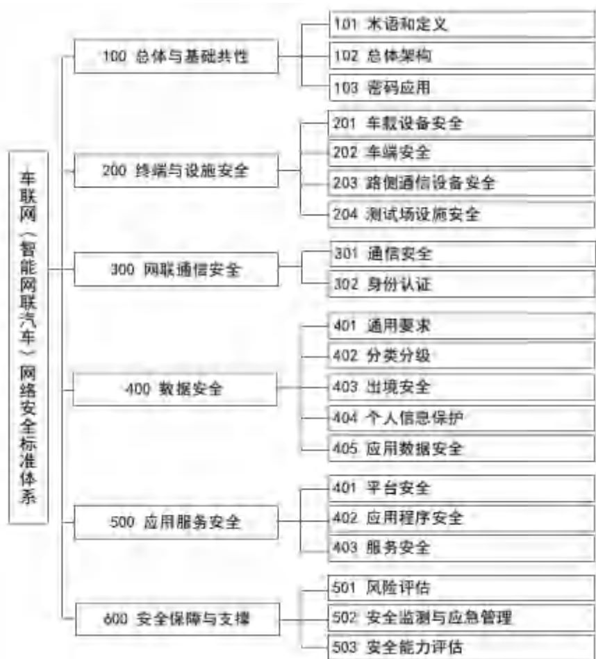
图 2 车联网（智能网联汽车）网络安全标准体系框架图
