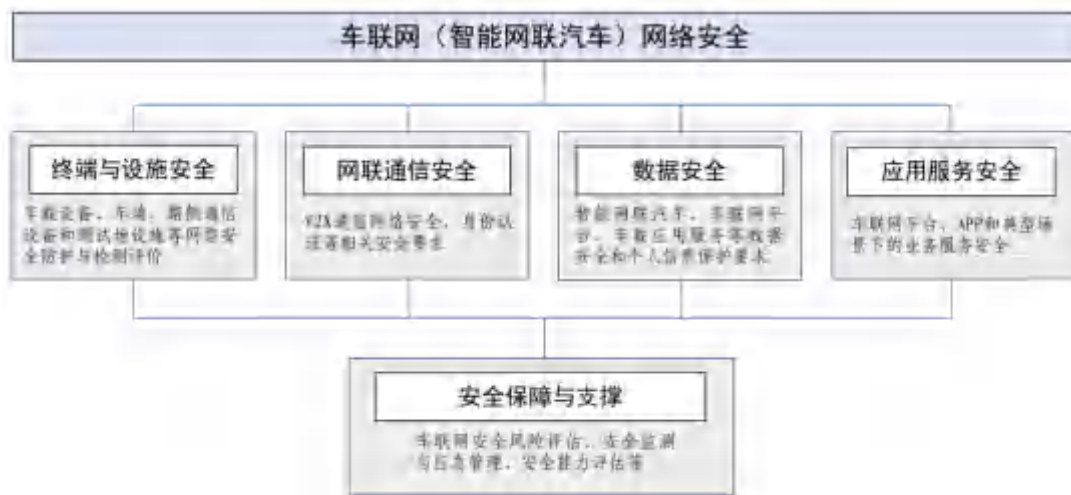
图 1 车联网（智能网联汽车）网络安全技术架构图
