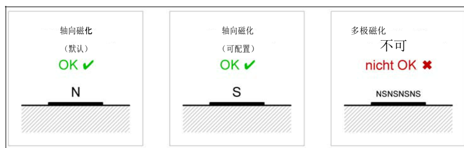
图 4 支持和不支持的磁条磁化
