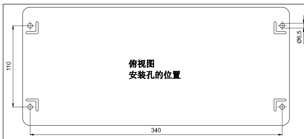
图5 地标天线安装孔
