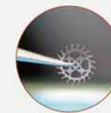
钟表制造 擒纵轮的切割 (铍青铜)
