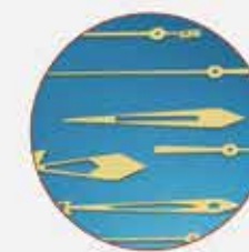
钟表制造 切割表针 (黄铜)
