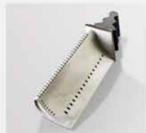
**航空航天：**涡轮叶片。在 TBC + 高温合金上以一种工艺钻孔扩散器和孔。
