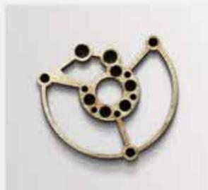
**制表：**陀飞轮桥板。切割 3 毫米黄铜：12 毫米/分钟
