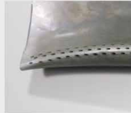
航空航天 涡轮叶片钻孔 (高温合金 + TBC)
