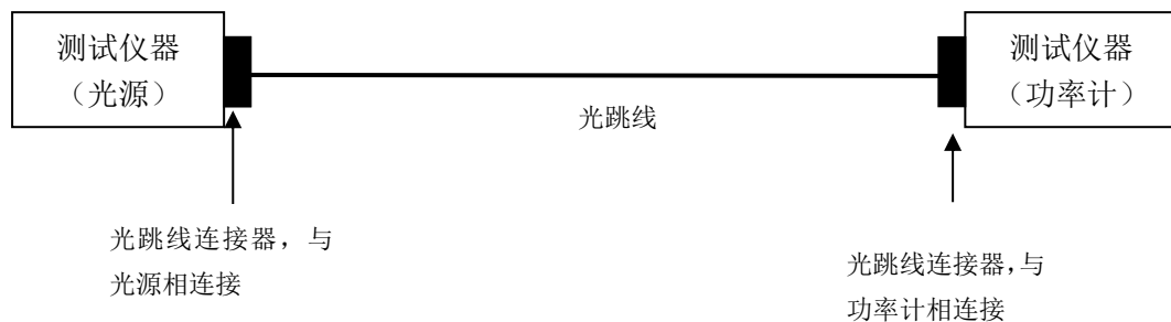
图 3.2.1-1 光纤链路衰减测试校准方式
