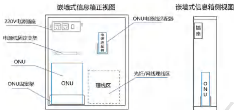
图 2-15 嵌墙式信息配线箱内部安装位置图（单台非 POE ONU）
