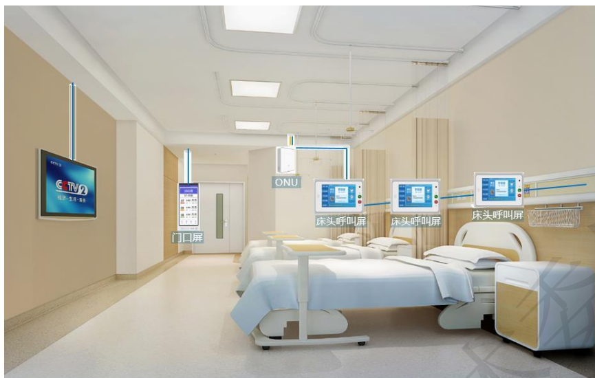
图 3-12 病房采用 F5G 全光网改造示意图
