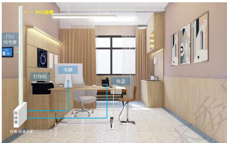
图 3-6 诊室采用 F5G 全光网改造示意图
