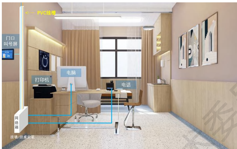
图 3-6 诊室采用 F5G 全光网改造示意图
