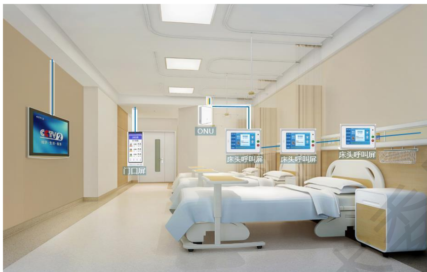
图 3-12 病房采用 F5G 全光网改造示意图
