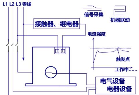
开关触点可通交流直流电流，可感性、容性、阻性的负载，也可以作为 PLC 信号采集使用。
