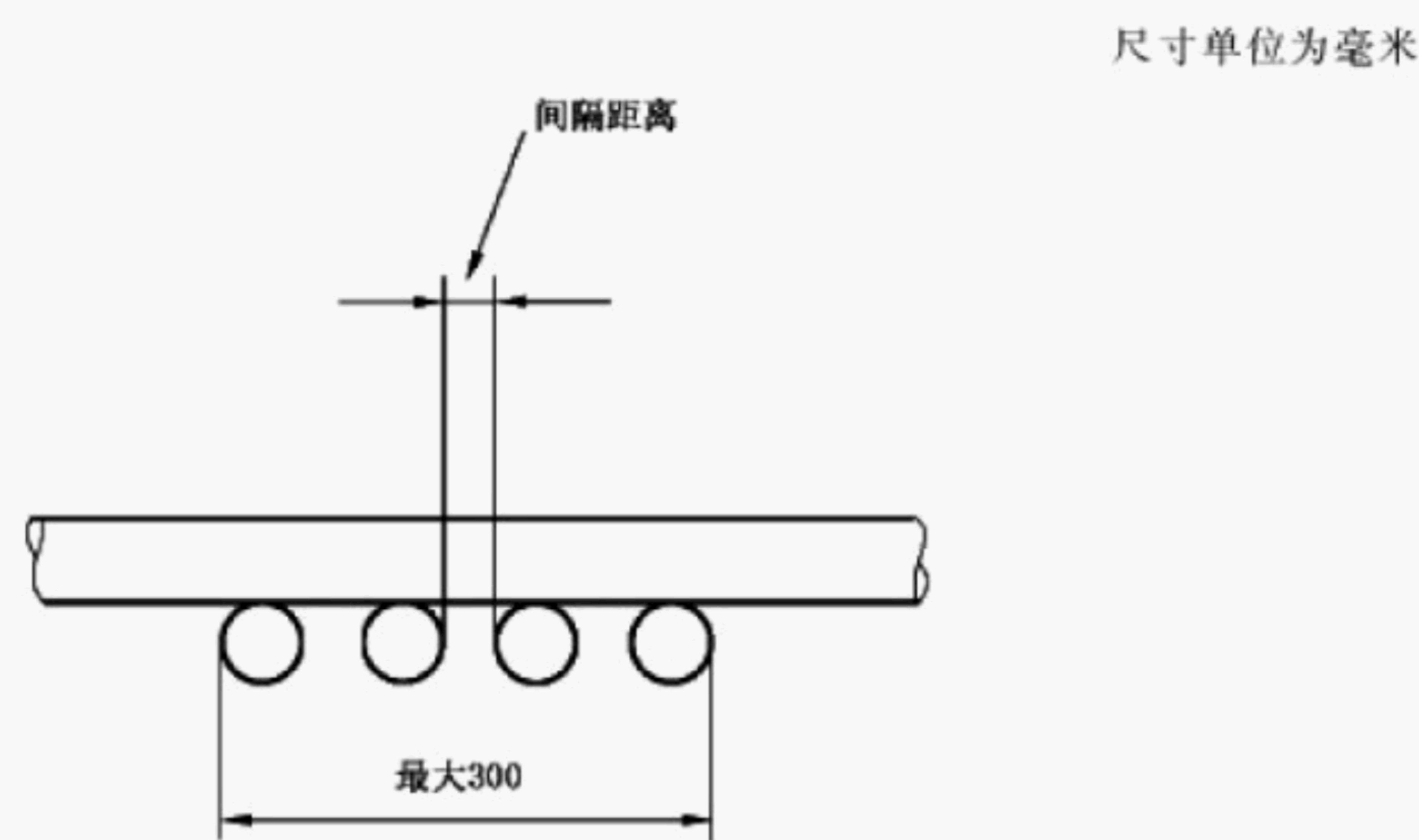
图 1 间隔安装在标准钢梯前面的电缆
