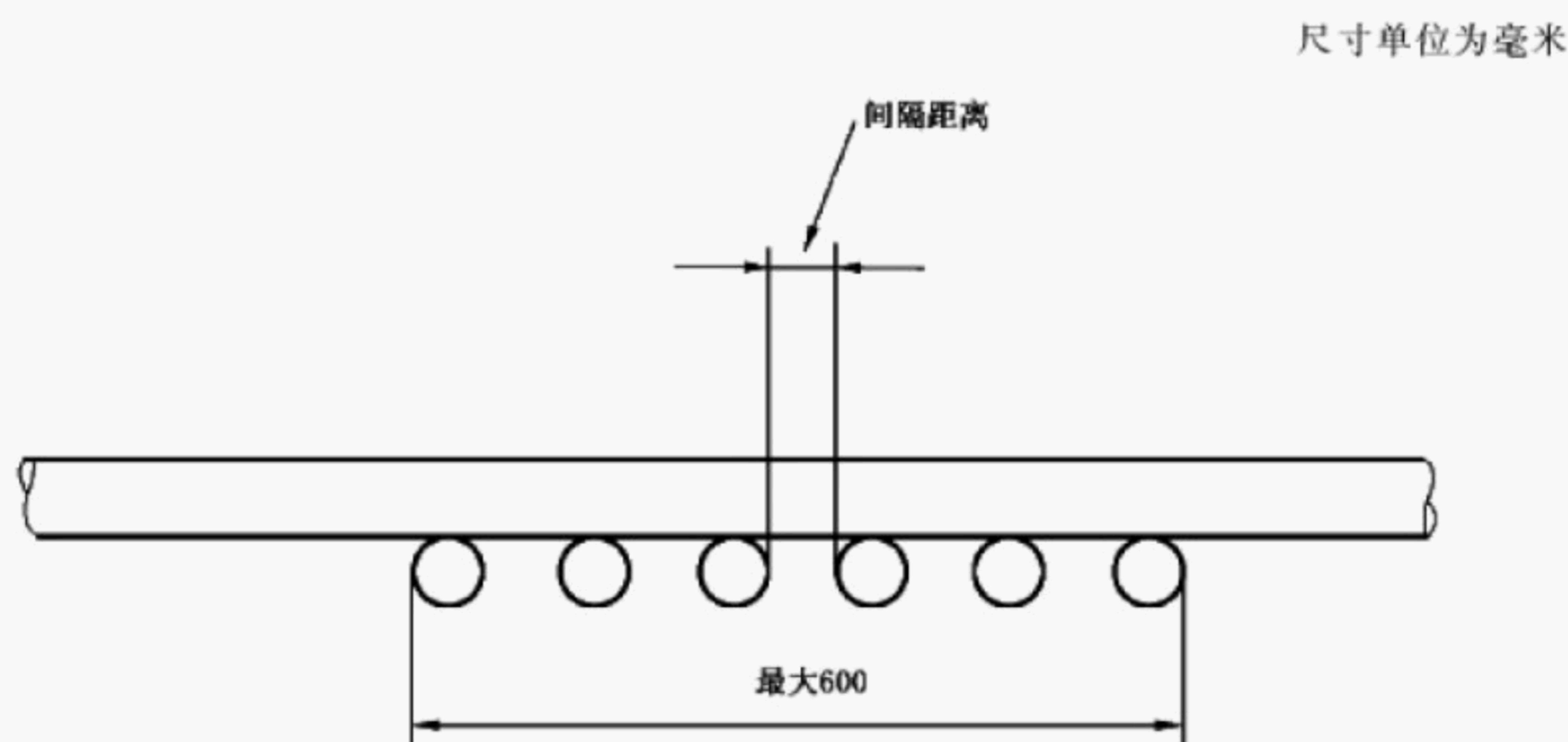
图 2 间隔安装在宽型钢梯前面的电缆
