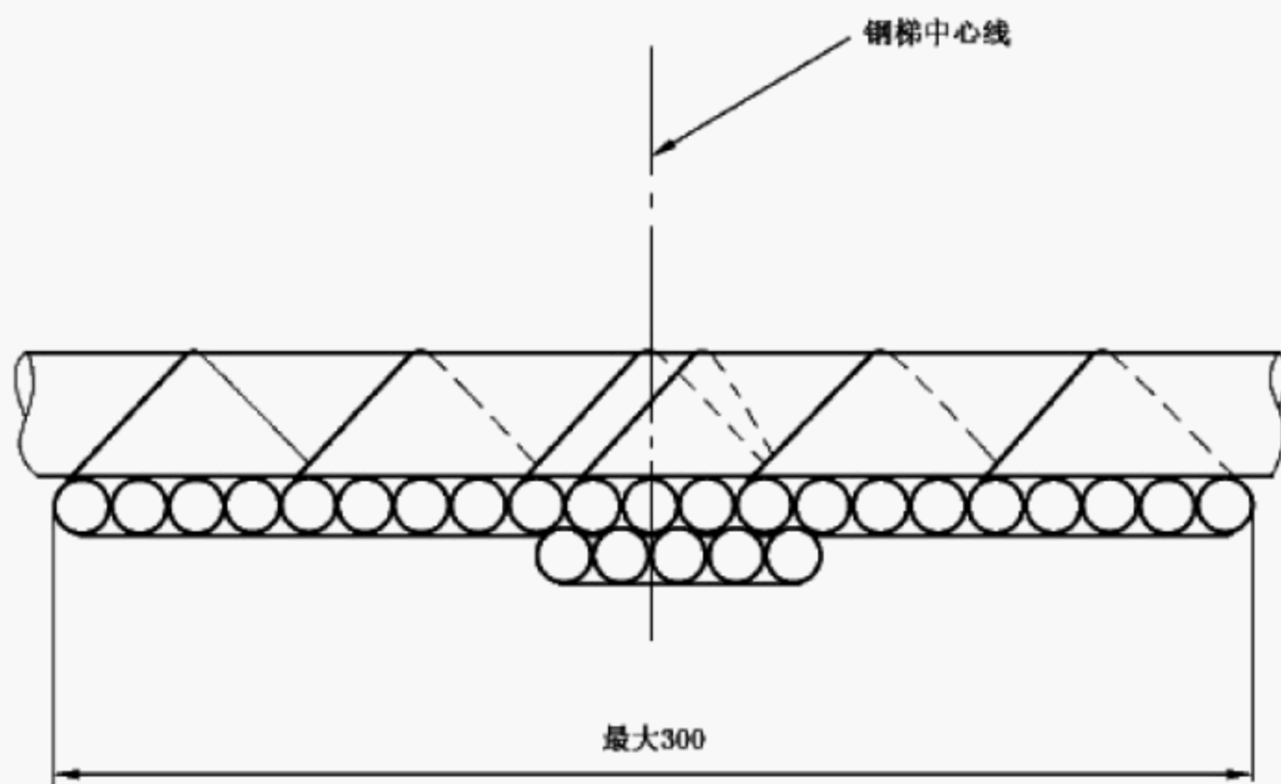
图 3 接触安装在标准钢梯前面的电缆(相互接触的电缆试样段组)
